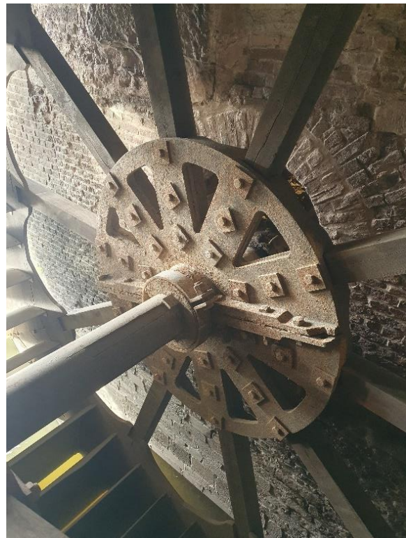
Fig. 100: Overzicht van het Poncelet-waterrad, buiten- (links) en binnenzicht (rechts). Het geheel wordt overspannen door troggewelfjes, deze constructie kan in de tweede helft van de 19 de eeuw / begin 20 ste eeuw gesitueerd worden en dus waarschijnlijk gelijktijdig met het plaatsen van het waterrad.
