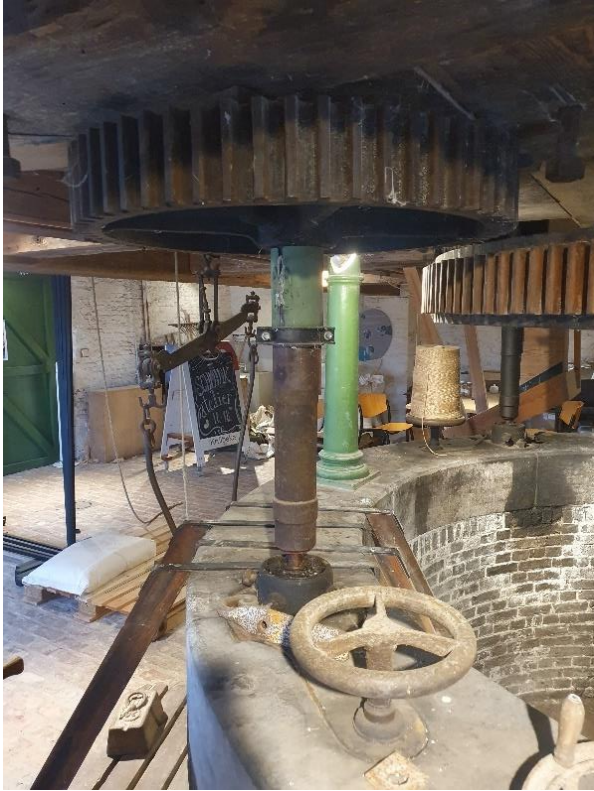
Fig. 114: Op de hardstenen boord van de asput staan vier identieke steenspinnen met sterrenwielen opgesteld die door het handwiel naar boven en onder kunnen geschoven worden, om zo aan te sluiten op het koningswiel en het bovenliggende steenkoppel in werking te zetten (links). Verschillende bijhorende alaaam staan opgesteld in kader van de museale werking van de molen, zoals de historische weegschaal en de houten schep. Dit zijn effectief historische gereedschappen aangezien deze op de foto's van 1945 ook reeds te zien waren. Op de achtergrond de asput waarop de gietijzeren zuiltjes zichtbaar zijn, waarvan er twee de bovenliggende staanders ondersteunen en twee de secundaire balkenstructuur dragen (rechts).
