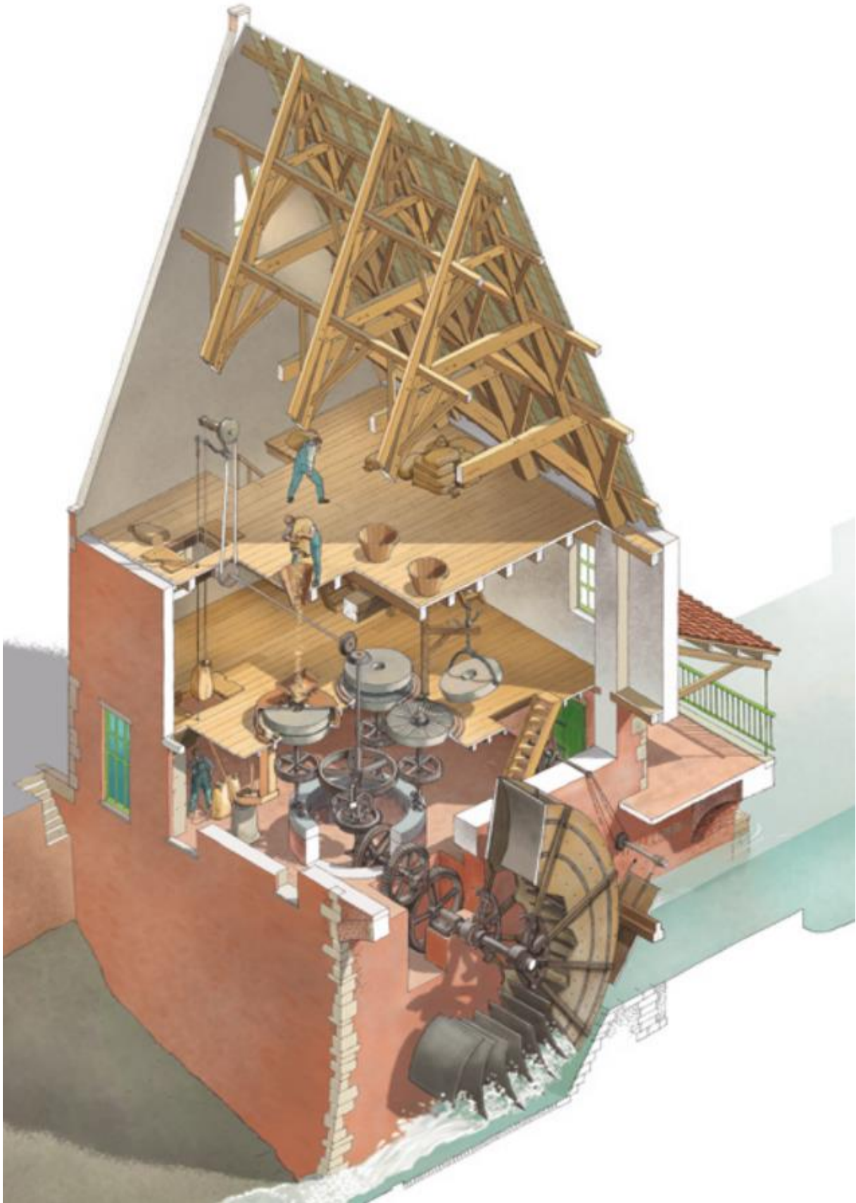
Fig. 22: Dwarsdoorsnede van de getijdenmolen van Rupelmonde, met schematische voorstelling van het maalmechanisme met Ponceletrad en vier maalstoelen (Het Geel Punt © Provincie Oost-Vlaanderen, overgenomen uit De getijdenmolen van Rupelmonde: 500 jaar malen op het getij van Kevin Poschet).
