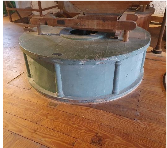
Fig. 128: Een van de steenkoppels is opengelegd, met onderaan de ligger die vast in de vloer ingewerkt zit en daarboven de looper (links), de overige drie zitten nog in hun houten steenkuip, gedecoreerd met halfzuiltjes (rechts).
