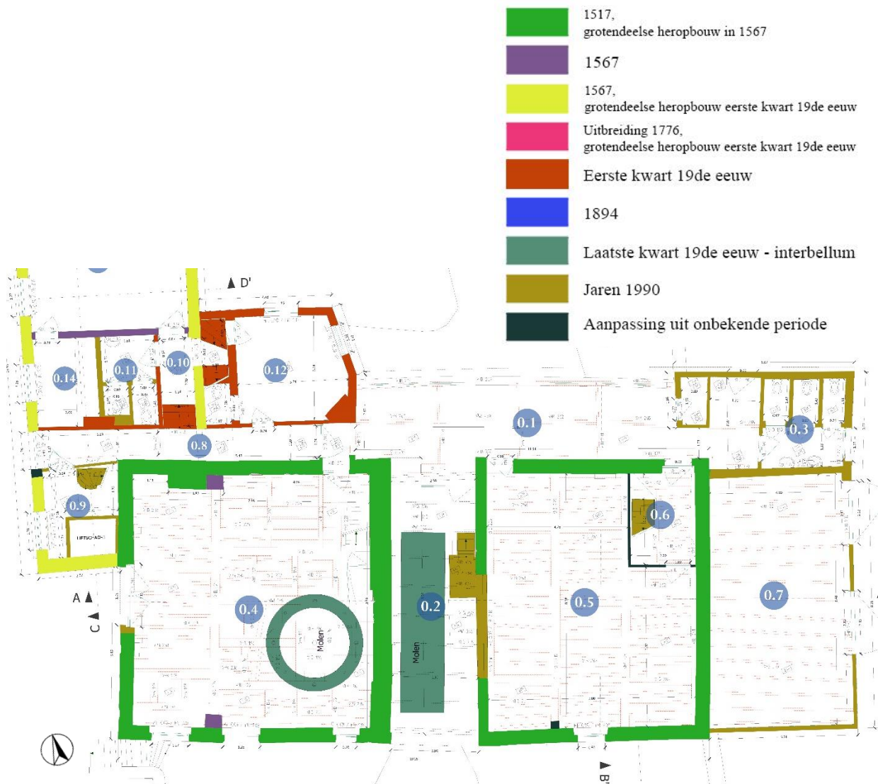
Fig. 92: Grondplan van de gelijkvloerse verdieping van de molen, met kamernummering en aanduiding van de bouwevolutie.
