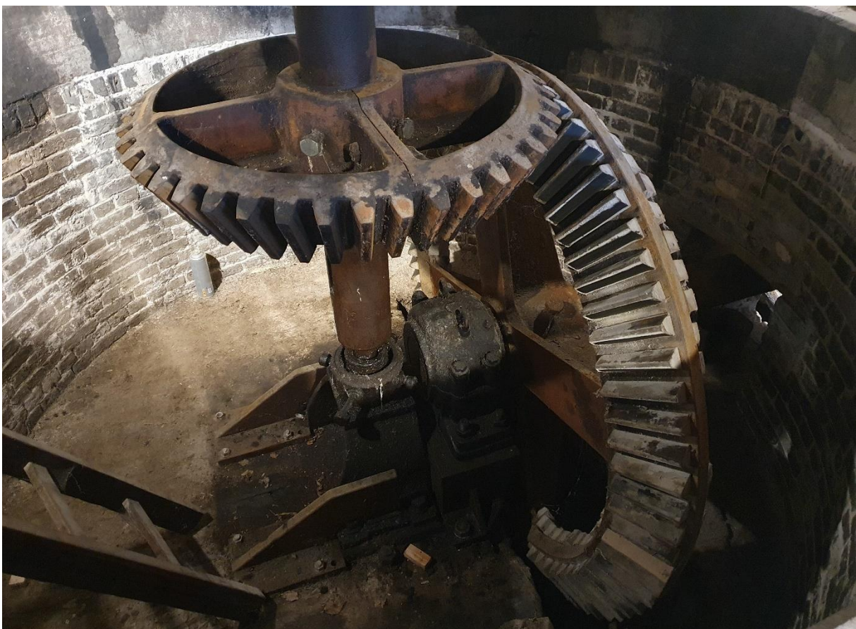
Fig. 113: Zicht in de bakstenen asput waarin twee assen in dezelfde metalen schoen draaien. Hier wordt door middel van conische wielen de draai beweging van verticaal naar horizontaal omgezet.
