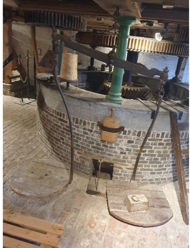
Fig. 114: Op de hardstenen boord van de asput staan vier identieke steenspinnen met sterrenwielen opgesteld die door het handwiel naar boven en onder kunnen geschoven worden, om zo aan te sluiten op het koningswiel en het bovenliggende steenkoppel in werking te zetten (links). Verschillende bijhorende alaaam staan opgesteld in kader van de museale werking van de molen, zoals de historische weegschaal en de houten schep. Dit zijn effectief historische gereedschappen aangezien deze op de foto's van 1945 ook reeds te zien waren. Op de achtergrond de asput waarop de gietijzeren zuiltjes zichtbaar zijn, waarvan er twee de bovenliggende staanders ondersteunen en twee de secundaire balkenstructuur dragen (rechts).
