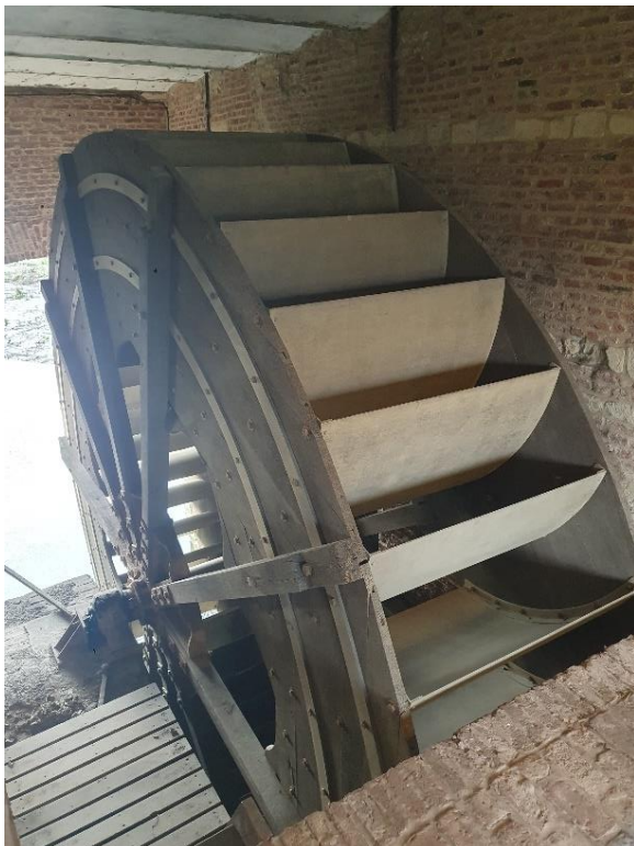
Fig. 100: Overzicht van het Poncelet-waterrad, buiten- (links) en binnenzicht (rechts). Het geheel wordt overspannen door troggewelfjes, deze constructie kan in de tweede helft van de 19 de eeuw / begin 20 ste eeuw gesitueerd worden en dus waarschijnlijk gelijktijdig met het plaatsen van het waterrad.
