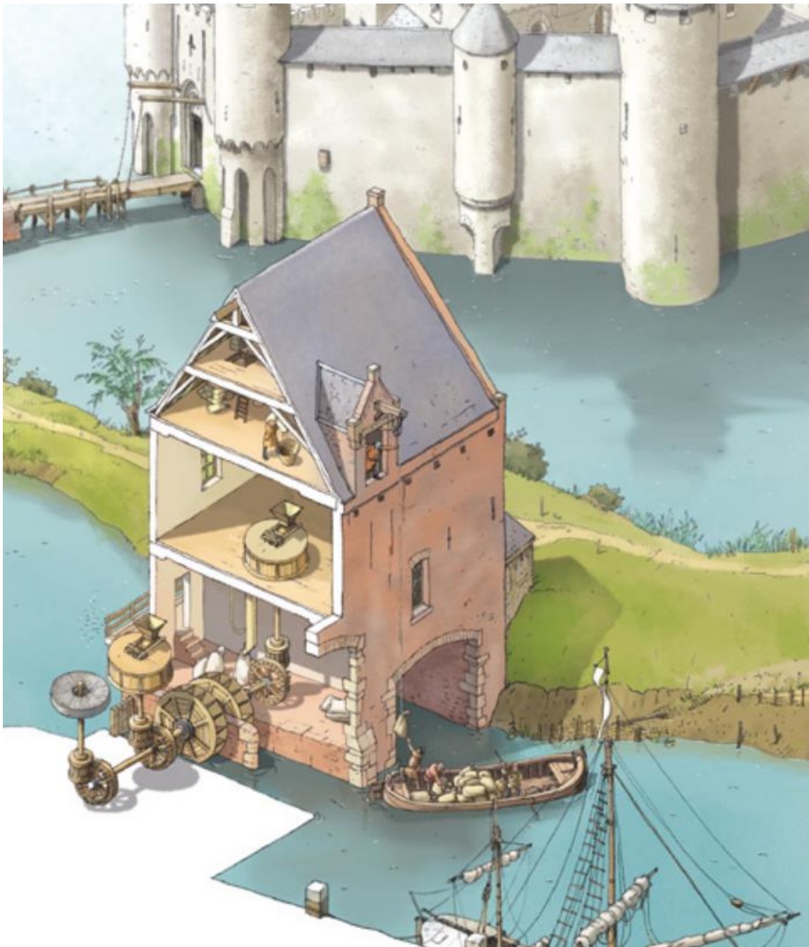
Fig. 11: Tegen 1519 begonnen de getijdenmolens te malen in de schaduw van het kasteel. De maalinrichting bleef min of meer ongewijzigd tot in de 20ste eeuw. De dakconstructie telde toen nog drie etages in de gebintes, tegenover vier bij de wederopbouw (Reconstructie Het Geel Punt © Provincie Oost-Vlaanderen, overgenomen uit De getijdenmolen van Rupelmonde: 500 jaar malen op het getij van Kevin Poschet).
