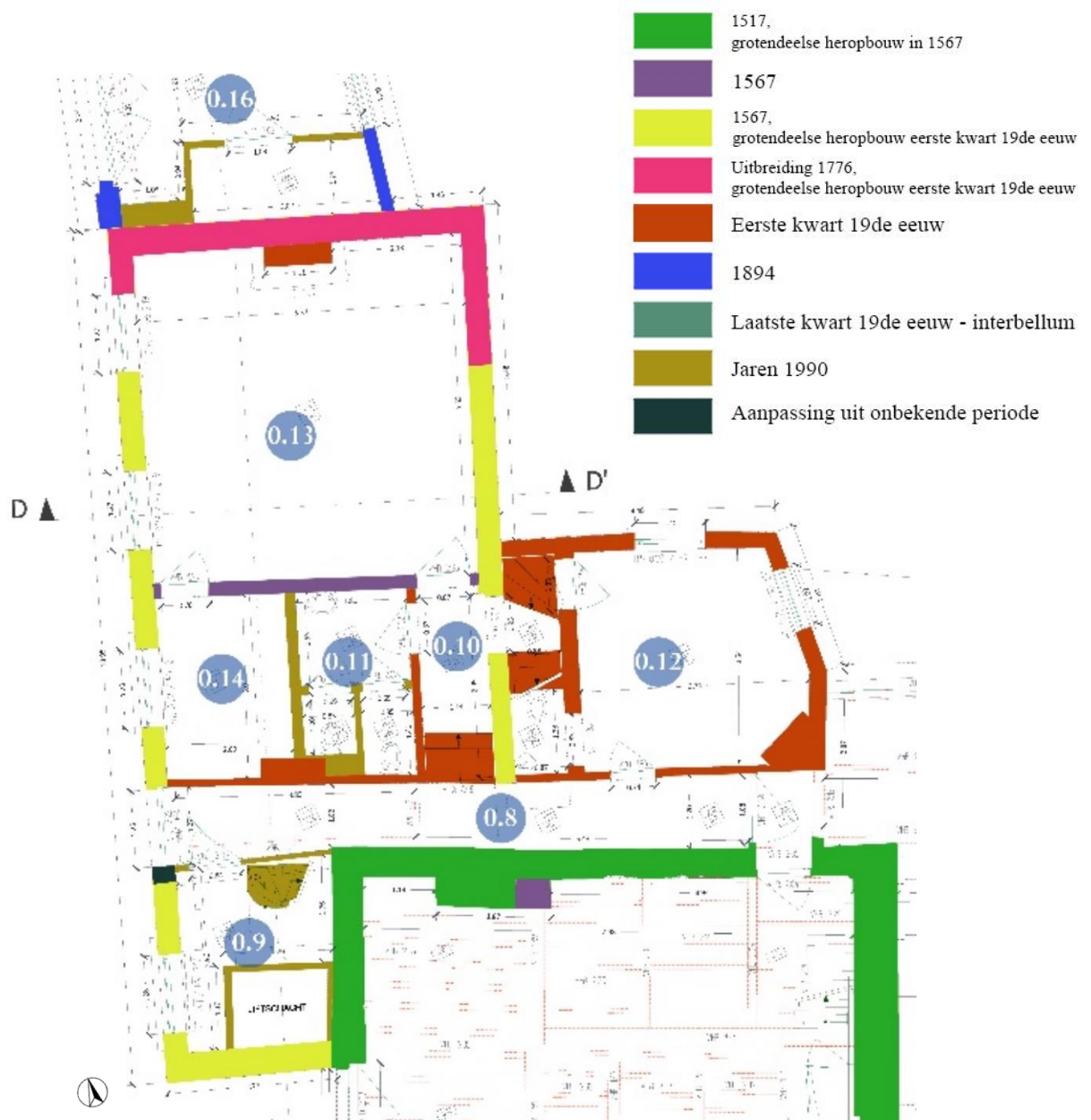
Fig. 148: Grondplan van de gelijkvloerse verdieping van de molenaarswoning, met kamernummering en aanduiding van de bouwevolutie.
