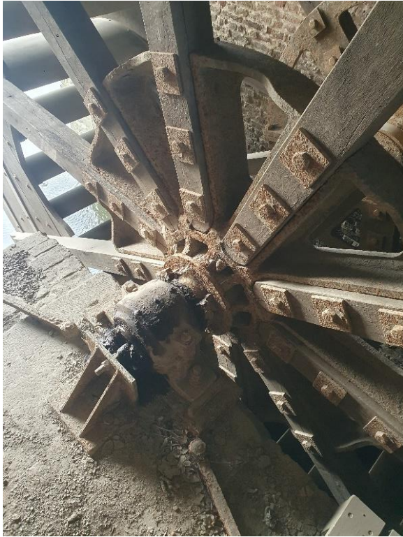
Fig. 101: De spil draait in een metalen schoen op een hardstenen kussenblok (links), vastgezet met trekankers (rechts).
