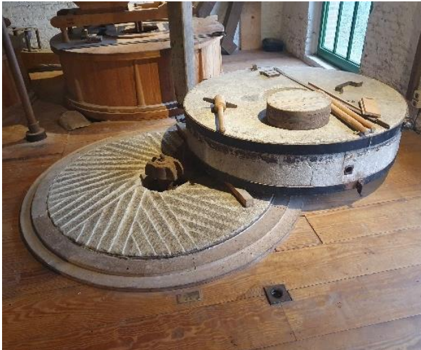
Fig. 128: Een van de steenkoppels is opengelegd, met onderaan de ligger die vast in de vloer ingewerkt zit en daarboven de looper (links), de overige drie zitten nog in hun houten steenkuip, gedecoreerd met halfzuiltjes (rechts).
