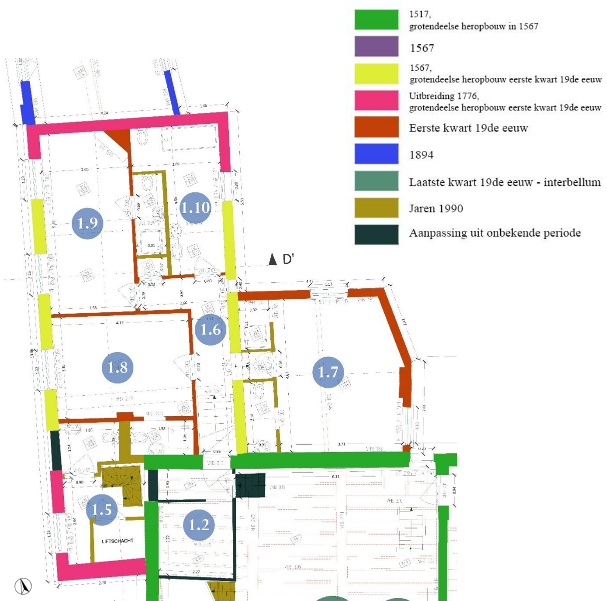
Fig. 161: Grondplan van de eerste verdieping van de molenaarswoning, met kamernummering en aanduiding van de bouwevolutie.
