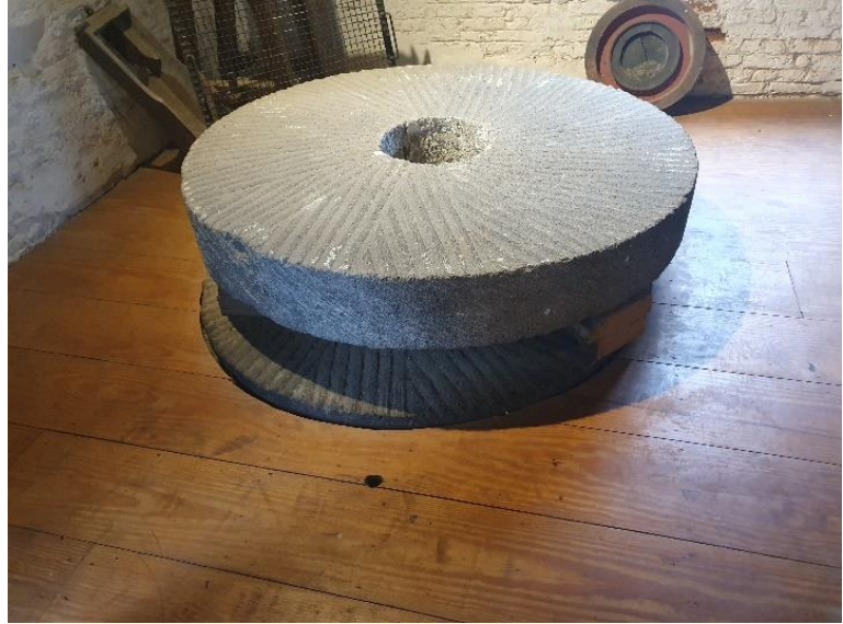
Fig. 127: Het luigat waar het luitouw doorloopt is afgesloten met een luik (links). In de zuidwesthoek een steenkoppel dat niet meer functioneel is, het werd pas onder de laatste molenaar toegevoegd en aangedreven met een inmiddels verdwenen dieselmotor (rechts).
