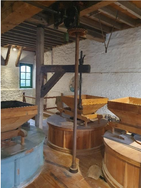
Fig. 129: Er is één steenkraan per twee steenkoppels voorzien om de looper open te leggen. Deze steenkranen staan op de gietijzeren zuiltjes op de onderliggende verdieping en dragen de zware last af naar de asput. Op de voorgrond is de koningsspil te zien die bovenaan aansluit op de luias (links). Het graan valt in de kaar, waarna het schuddebakje daaronder het gelijkmatig verdeelt langs het kroggat van de looper (rechts).
