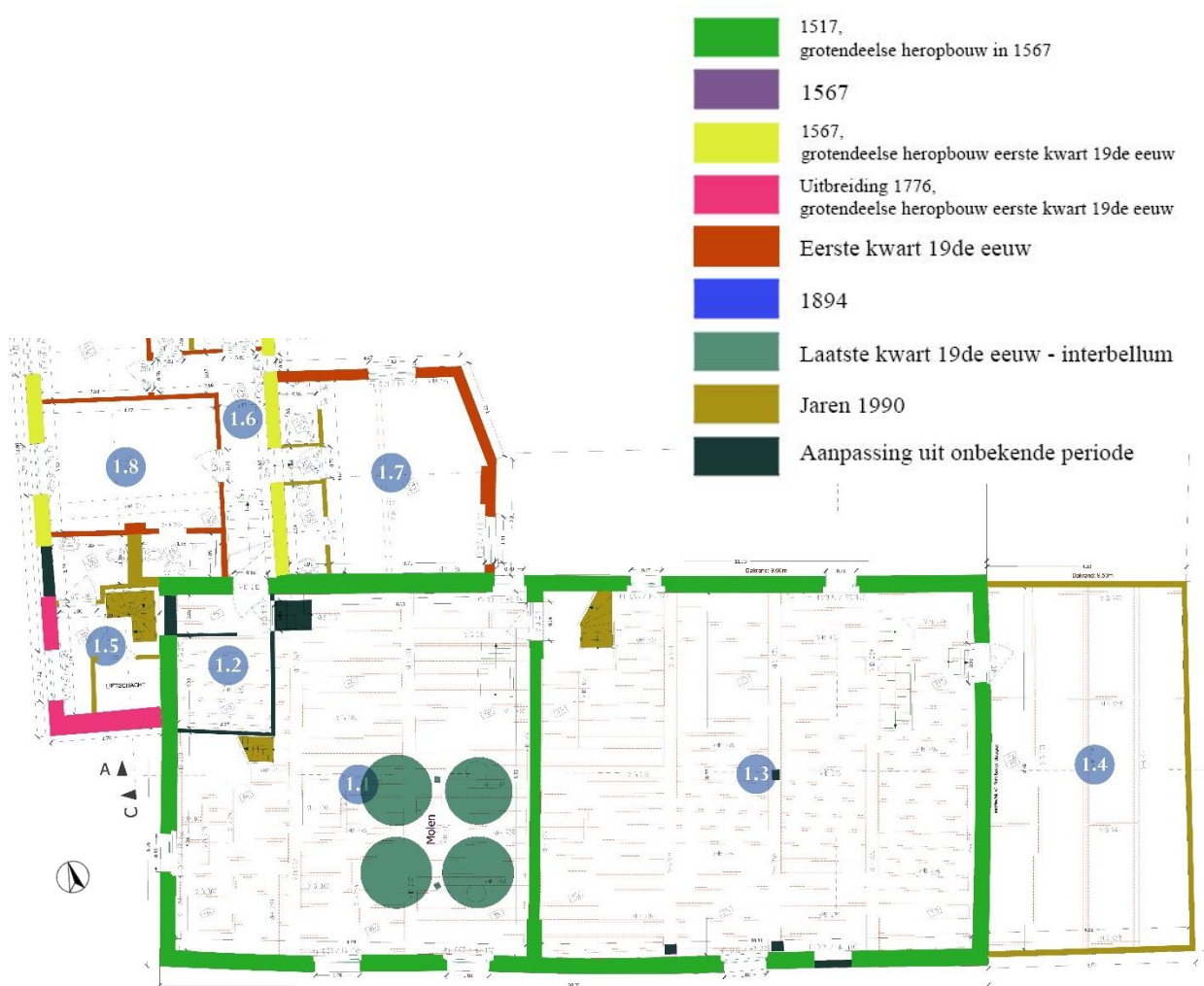
Fig. 120: Grondplan van de eerste verdieping van de molen, met kamernummering en aanduiding van de bouwevolutie.
