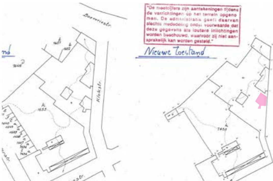
33. Kadastrale mutatieschets 1969 (voor en na wijziging en met aanduiding op de nieuwe toestand van de gewijzigde/toegevoegde delen) (FOD Financiën | Patrimoniumdocumentatie, Brugge 4e afd, sectie D, 1968, nr. 35)
